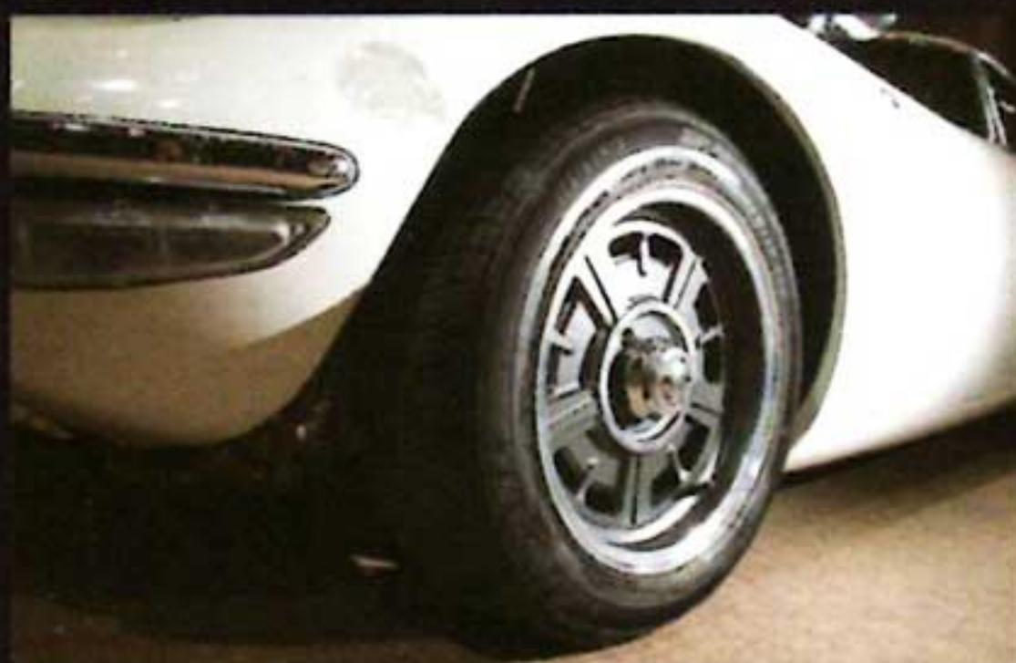
2000GT定番のマグネシウムホイールも、アルミ削り出しで完全に再現。タイヤはダンロップS Pスポーツで、前後175/65R15を装着。サスペンションはダブルウィッシュボーンレイアウトとなっている。
